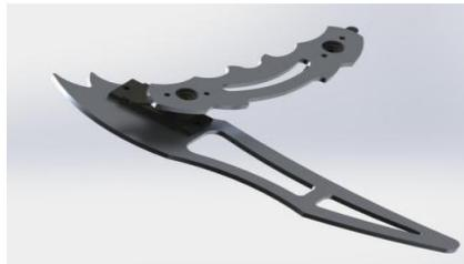
Рисунок 5 – Конструкция ноги гексапода
