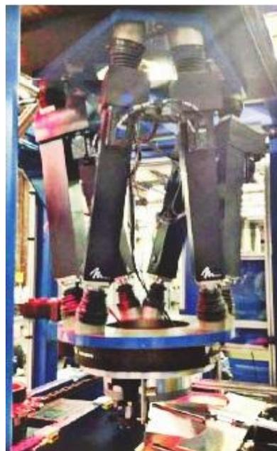
Рисунок 1 – Станок гексапод P3000 фирмы Mikrolar (США)
